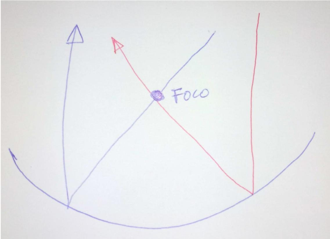
Con los espejos parabólicos teníamos dos imágenes reflejadas, una boca arriba y otra boca abajo, como si el escarabajo estuviera sobre un cristal, y estuviéramos viendo el escarabajo y su reflejo.
