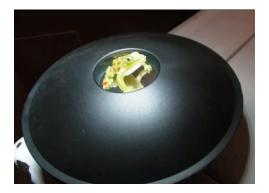
Figura 8. Ilusión óptica formada mediante el empleo de dos espejos parabólicos
